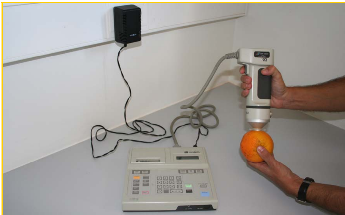
Fotografia 4 – Determinação da cor do flavedo, pelo sistema de coordenadas “Hunter-Lab”. Fotografia captada no laboratório de hortofruticultura, a 10-Maio-2006.
