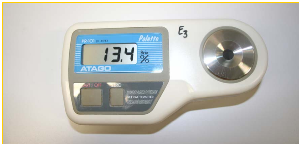
Fotografia 6 – Determinação do teor de sólidos solúveis, em °Brix. Fotografia captada no laboratório de hortofruticultura, a 19-Março-2006.
