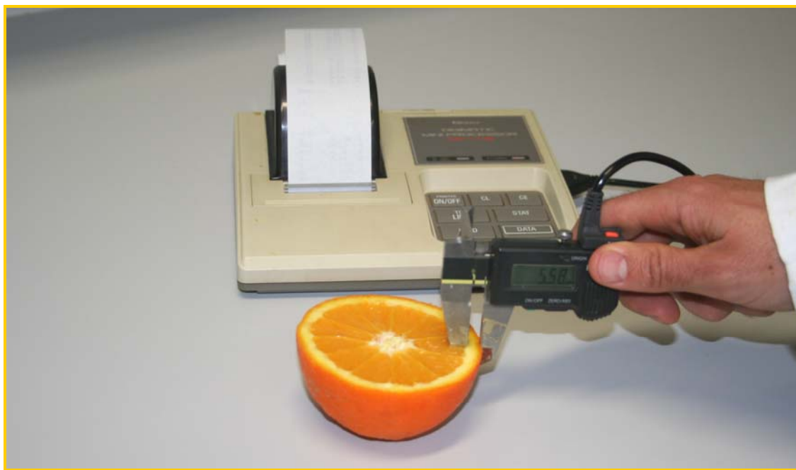
Fotografia 5 – Medição da espessura da casca efectuada na zona equatorial do fruto. Fotografia captada no laboratório de hortofruticultura, a 28-Janeiro-2006.
